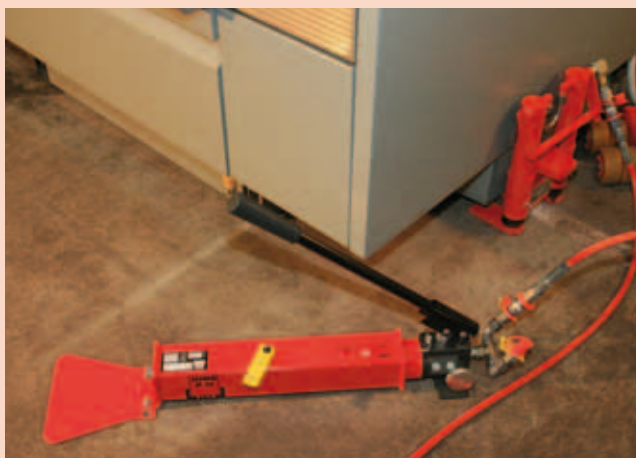
Ручной насос JP 26 в работе с нашим домкратом Primus 13
