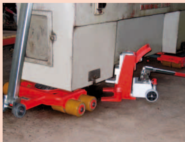
JH 10 G plus с тележками серии К в работе
